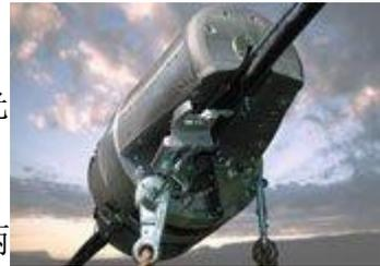
C2 型捆扎机与其它所有吉美通捆扎机一样经久耐用. 零件采用合金钢, 不锈钢, 铜铸件, 运用计算机数控 (CNC) 技术控制机加工精度, 并经过防腐处理, 采用齿轮传动和密封轴承, 能最大限度地提高耐用性, 并将维护降低到最低限度。
